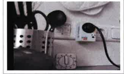
Der ambiact ist ein Stromsensor, der automatisch einen Notruf erzeugt, sobald ein Haushaltsgerät untypisch lange nicht verwendet wurde.
